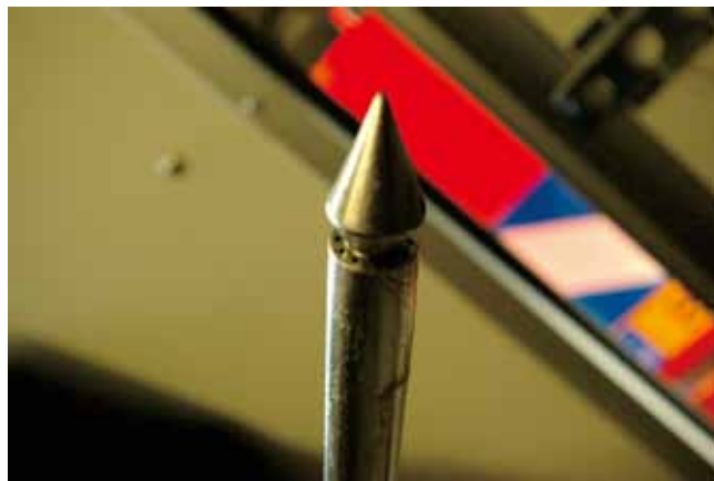
写真 17 植物性屋根の消防隊用の資機材その 1（内部注水用の資機材）
